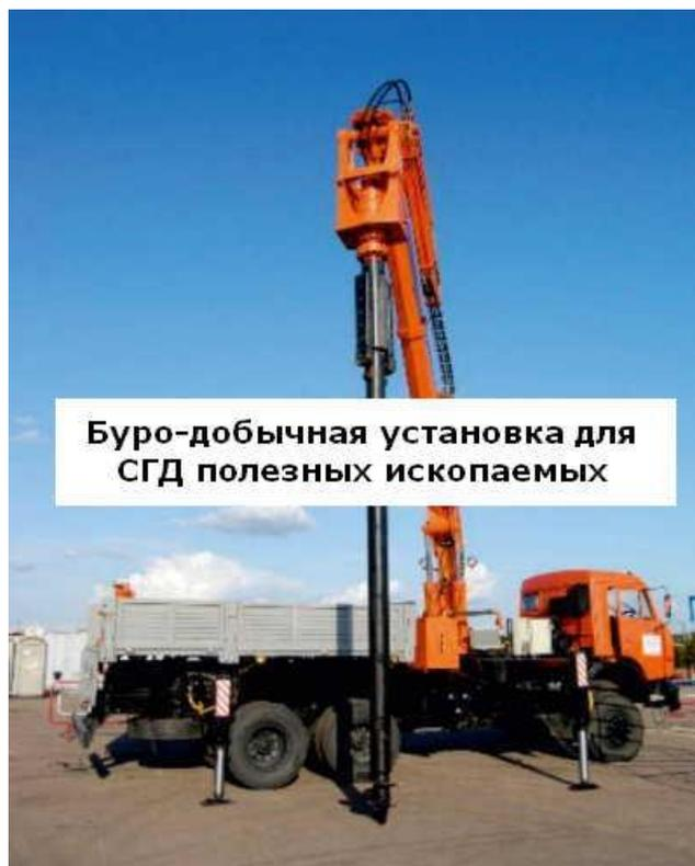
Предлагаемое оборудование скважинной гидродобычи комплектуется и поставляется в модульно-мобильном исполнении конкретно для той местности и условий, где будет применено на разработке полезных ископаемых.
